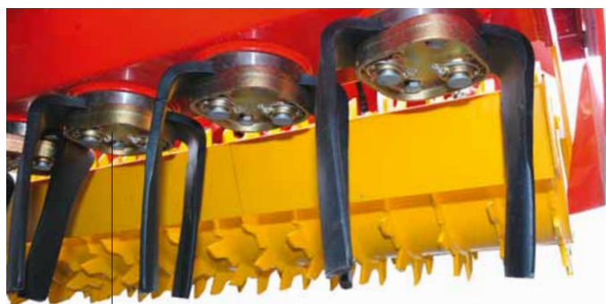
Bout en splitpen zijn optimaal tegen vuil beschermd.
